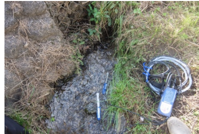
(左) 採水した水を現場で即時に測定 (EC, 水温, pH 他), (右) 対象水中にセンサーを直接投入した測定
