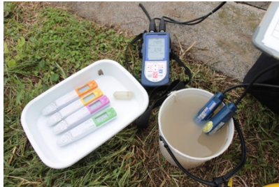
(左) 採水した水を現場で即時に測定 (EC, 水温, pH 他), (右) 対象水中にセンサーを直接投入した測定
