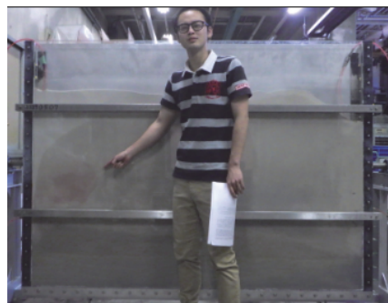
写真-5.1 新たに導入した 新型土槽 (内寸高さ140cm)
