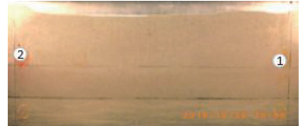
写真-2.30 実験終了時 (27.5 時間後 合計 12.5PV 残留 1%)
