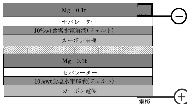
図 9 Mg 電池直列図(2S 時)
