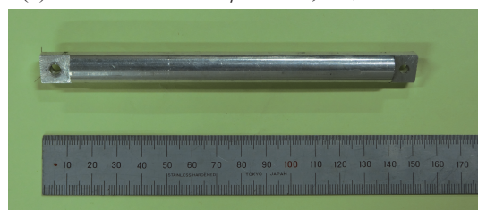
(b) 金属製丸棒 ( \phi 13\text{ mm} )
