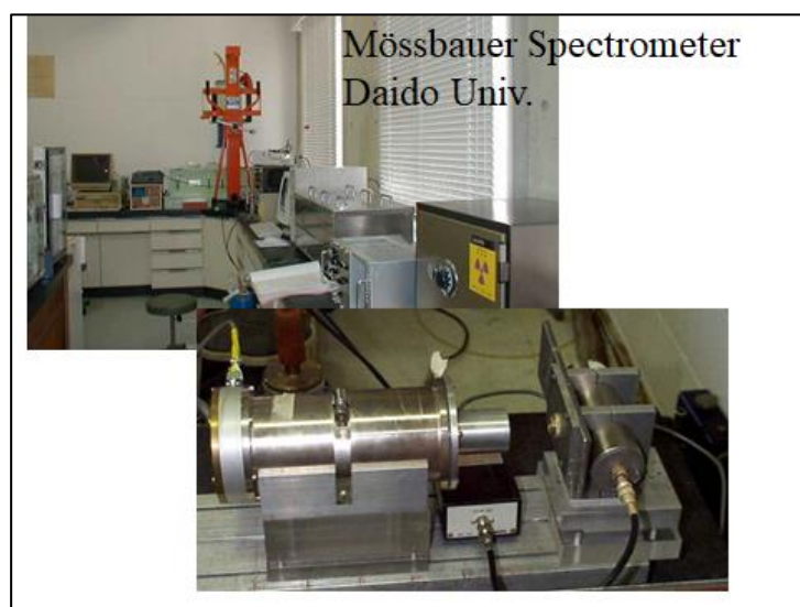
図2-7 メスバウアー分光分析装置の全体構成図(上図)と本研究で用いた装置の全体の写真(下図の上)、線源、試料、 \gamma 線検出器部分の写真(下図の下)
