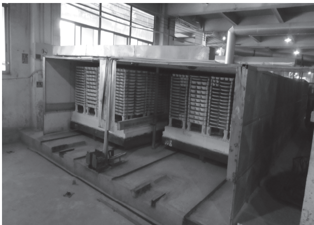
写真5 ガストンネル窯の内部（松木撮影）
