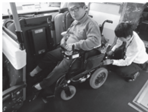
写真-2 固定実地の様子
